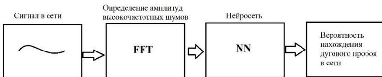
Рис. 1. Общая схема детекции дугового пробоя
